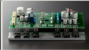
Eigene Stromversorgung für Signaleingangsstufe
