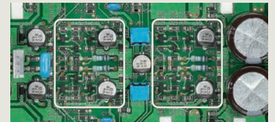
2-fach parallele Schaltanordnung der MCS+-Architektur
