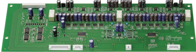
■ Die AAVA-Lautstärkeregelungs-Platine mit Rauschminderung
