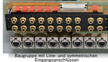
Baugruppe mit Line- und symmetrischen Eingangsanschlüssen
