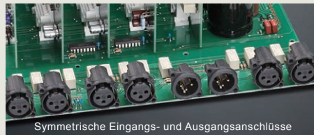
Symmetrische Eingangs- und Ausgangsanschlüsse
