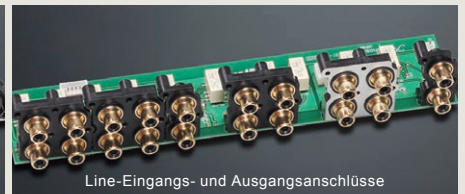
Line-Eingangs- und Ausgangsanschlüsse
